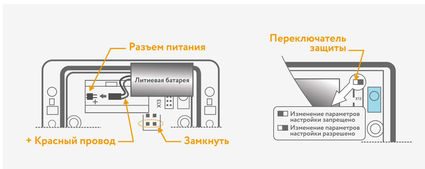
Рис.Л1–Порядок подключения батареи Рис. Л2 – Переключатель защиты
