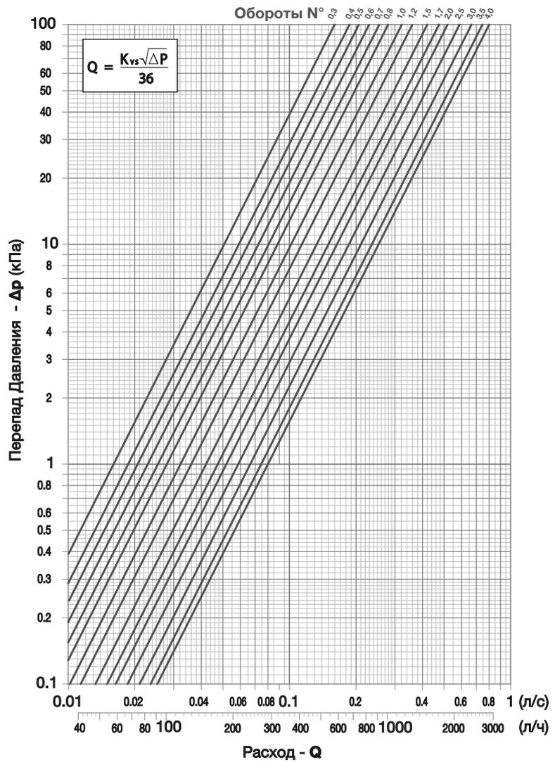
Kv (расход в м<sup>3</sup>/ч при перепаде давления 1 бар)
