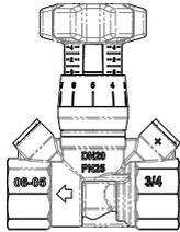
Cim 787R - Балансировочный клапан-С переменной диафрагмой-PN 25-с заглушками
